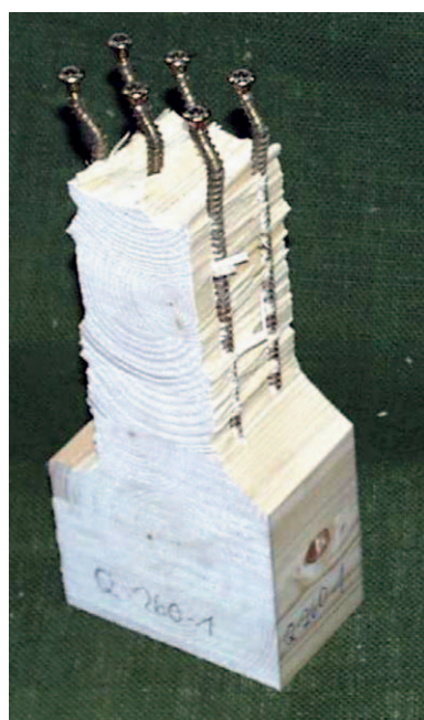
Diese Vollgewindeschrauben dienen in einem Versuch als Querdruckverstärkung eines Auflagers. Die Last war zu groß – die Verbindungsmittel knickten aus
